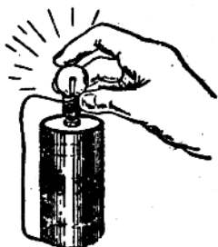
图 6 电流通过灯泡的时候，灯泡就亮了，电流断了的时候，灯泡就灭了。
