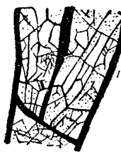
替換黃銅礦的海綿格狀構造
