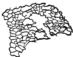
替換閃鋅礦的海綿網狀構造
