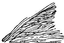
替換方鉛礦的放射狀構造
