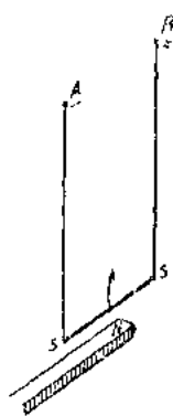
第9圖 電流通過可動導線S-S時，後者即偏向右後
