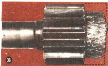
图36所示为损坏的最终驱动小齿轮。小齿轮齿内的接触部分完全损坏。这可能是由于重载荷或润滑不
