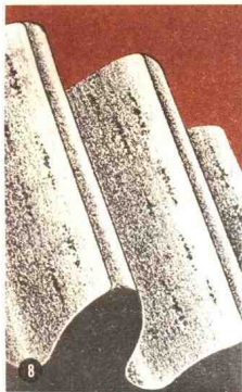
腐蚀磨损示于图8。是由润滑油中的污染物或添加剂引起的。
