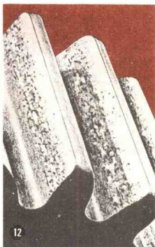
与上述相反,图12中所示有害的麻点大约是因载荷过大而造成的。
