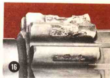
图16中的驱动小齿轮出现严重的麻点和剥落,在相邻的齿上,轮齿彻底毁坏。
