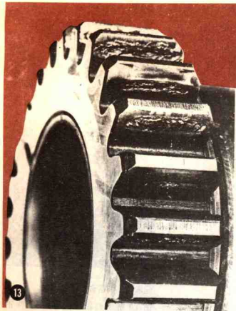
麻点损坏了图13中正齿轮的齿面。
