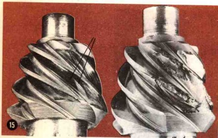
剥落的第一阶段,在齿的接触地区有纵长扩展的裂纹,如图15左面所
