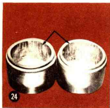
疲劳损坏也出现在U形万向节轴承杯的内孔中(图 24)。
