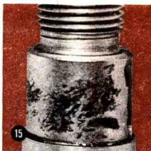
图 15 中的润滑油泵驱动内齿轮轴是腐蚀磨损的证据。长期的磨损可能造成疲劳破坏。
