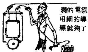
粗的電纜可輸送極大的電流
