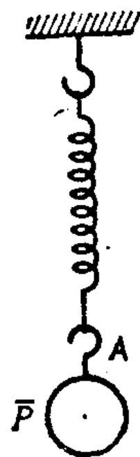
圖 1.1 重物 P 的重量與彈簧的彈力平衡。
