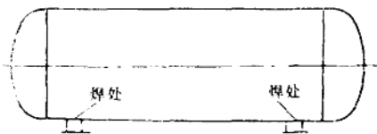
图3-1-20 锅筒两端焊死不能自由伸缩
