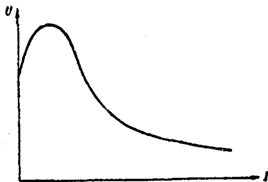
圖2.3 稳定电弧放电的伏安特性曲线。
