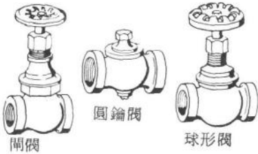
圖 1-2 住宅管路中常用的三種水閥
