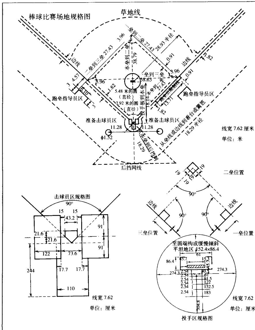
棒球场地如图所示。画线的顺序是先确定本垒的位置，然后测定二垒。以本垒和二垒为基点确定一、三垒。本垒的中心位于一垒线和三垒线的交点上。距离为 27.43 米的内场线与本垒在同一水平面上，投手板比本垒高出 25.4 厘米。
