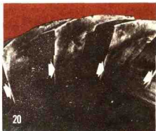
这种作用还可能在胎面花纹的棱上造成一系列的裂纹(图20),裂纹有时延伸到胎侧,如图所示。
