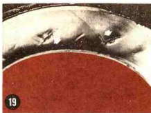
在农业拖拉机上,在犁沟里的轮胎由于拖拉机的侧斜可能受伤。侧斜使轮胎受到严重的折叠作用,特别是当轮胎充气压力过低时,会使轮胎靠里侧的侧壁最后分割成一系列的破口(图19)。
