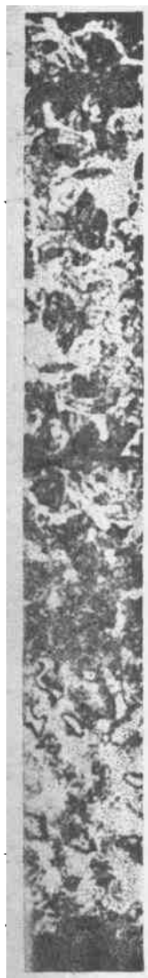
圖 4 38X-M10A 號鋼受熱層的顯微組織
