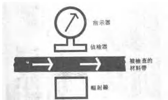
圖8 一種簡單的輻射厚度規，來自輻射源的輻射被受檢查的材料衰減，當厚度增加的時候，到達偵檢器的輻射強度就減小，假如用已知的厚度校正過偵檢器的讀數，那麼偵檢器就可以用來指示受檢查的材料厚度。
