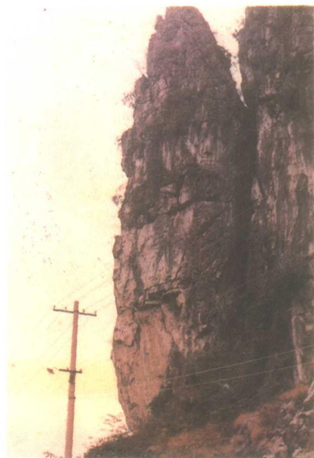
图版14 东郊羊角山山坡开裂，裂缝宽 0.5 \sim 1.5m ，直通山脚
