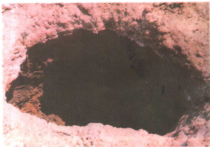
图版 12 五里店三砖厂二级阶地粘土卵石层中发育的 土洞及塌陷
