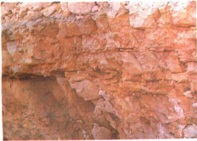
图版 3 三里店桂林海关地基的下第三系粉砂质泥岩
