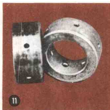
青铜径向滑动轴承在过热时将失去镀锡层并且变色。图11中(左)的镀层磨损,并且以斑点状磨失。右侧是一新轴承。
