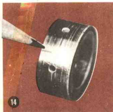
因为润滑油被污染,轴承外表面擦伤和磨损,并且镀层被磨去(图14)。
