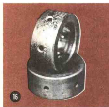
润滑油中的污染物可以嵌入铝合金轴承表面(图16),并在轴的轴颈和轴承上造成重磨损。
