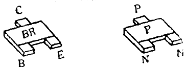
图3a 片状二极管、片状三极管引脚示意图
