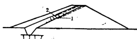
图 1-2 斜墙纵缝 1—斜墙沉降；2—纵缝
