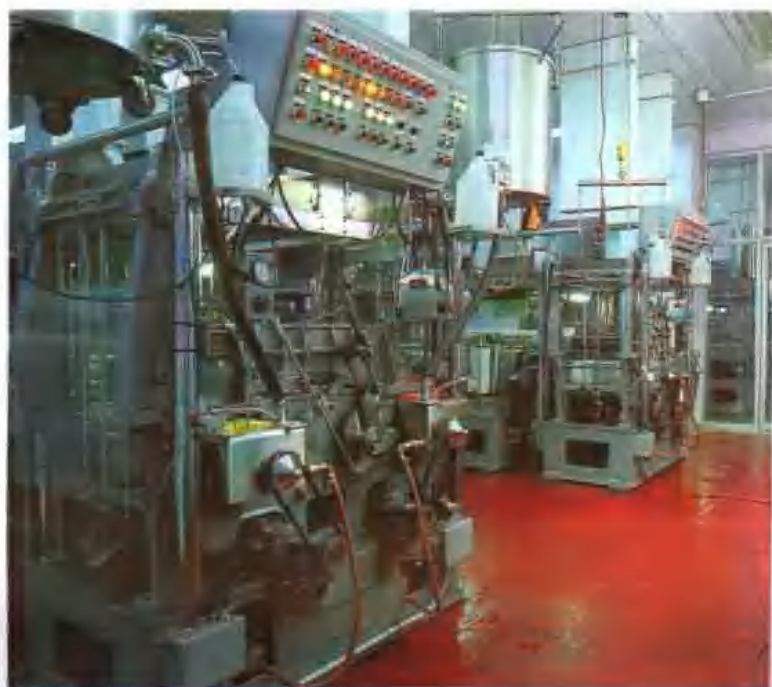
北京第三制药厂药用空心胶囊生产线。
