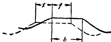
圖 385. 銑刀切削刀的疊合。
