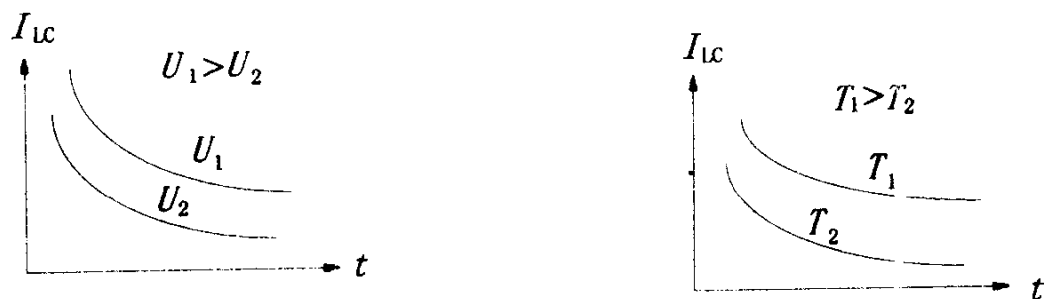
图 1-4 电解电容器的漏电流与测试时间、施加电压和环境温度的关系
