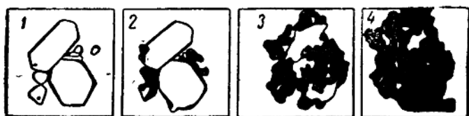
图4 乳剂颗粒群显影的顺序阶段(1,2,3,4)
