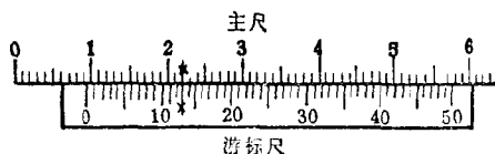
图16 0.02毫米游标卡尺的讀法。
