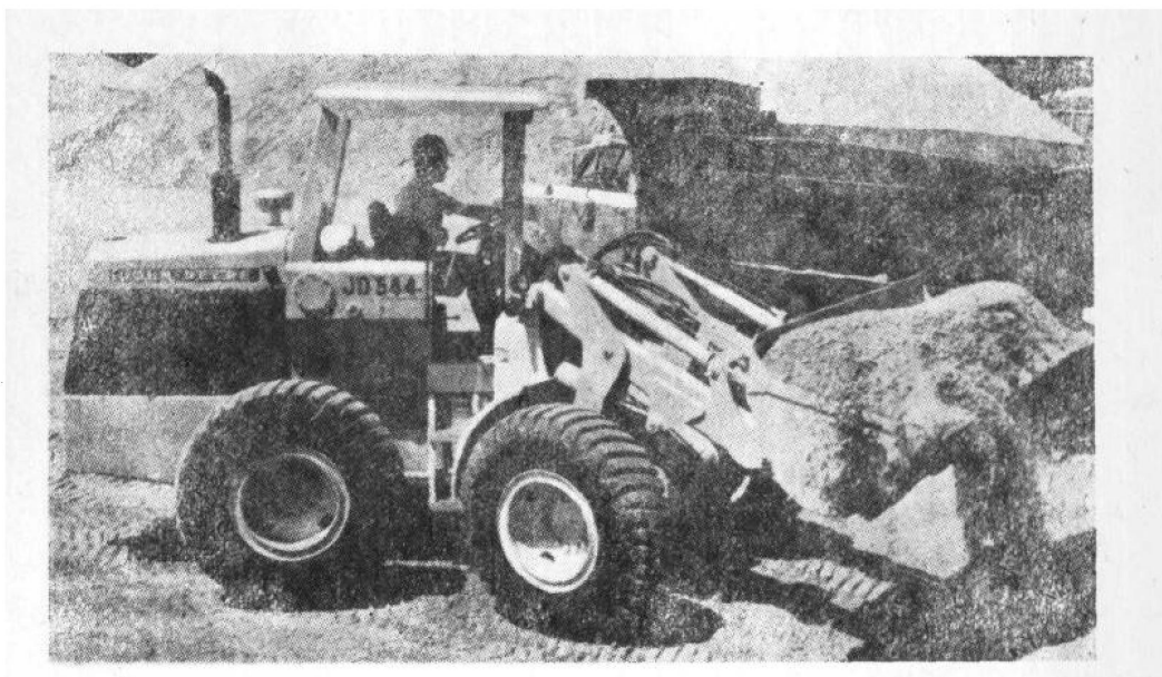
图 2-1 铰接式装载机可减小回转半径和缩短工作循环
