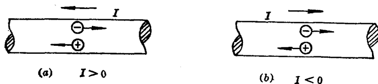
图 1-3 电流的实际方向与正方向
