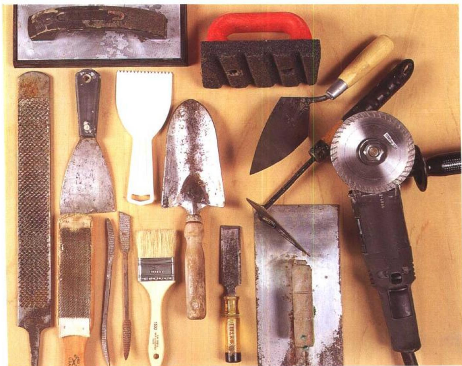
混凝土工具从顶部开始依次为：橡皮板、磨擦板；中间为：油灰刀、锯齿状的塑胶油灰刀、园艺泥铲、勾缝刀、小锄头；下部为：粗齿锉、钢丝刷、曲锉、毛刷、凿子、抹子。
