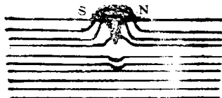
图 1-1 磁粉探伤原理
