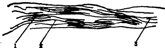
图1-1 纤维素分子在纤维中的排列示意图
