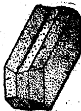
圖6.菱體雙晶，雙晶面 \{0001\}
