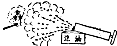
圖 1.2 汽油雖少力量強大 (汽油汽化成小粒和空氣充份混合)
