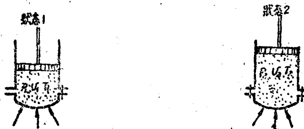
图 1-2 气体在具有运动活塞的汽缸中
