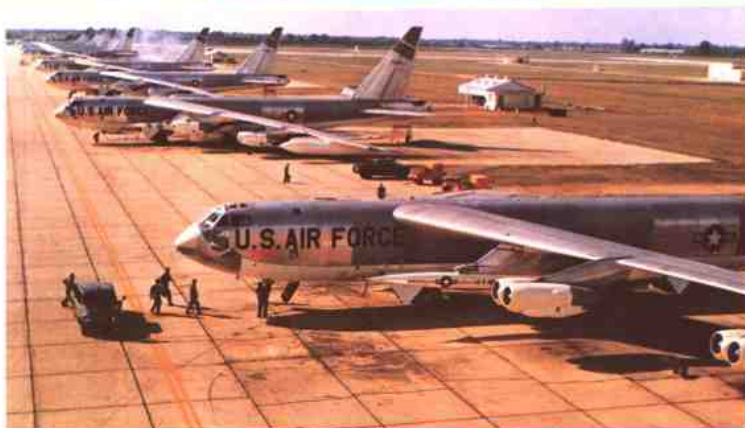
美国空军八发动机B-52“同温层堡垒”重型轰炸机。本图摄于1967年。图中的B-52轰炸机翼下挂载的是AGM-28“大猎犬”防区外发射导弹。
