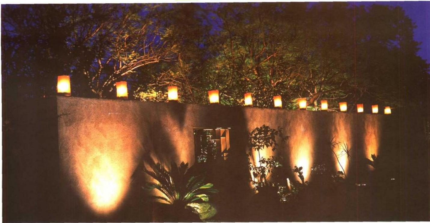
为了使反射灯凸现一面墙的特征，应把光源（灯）放置在靠近墙的地方，并且灯头微微上倾。灯光掠过墙面，展示墙的纹理，并且在墙面上留下斑驳的影子。如果墙面有装饰钉，或者精致的砖墙，或者墙的前面有非常低矮有趣的植物（例如装饰草），此时宜采用反射灯。即使墙的前面没有一些有趣的植物，也可以采用反射灯，因为明亮的照射可以展现树木所有的特色。
