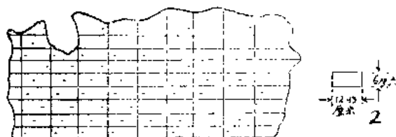
图 17 測定猪皮各部位厚度时生皮肉面上的划分綫
