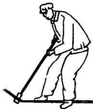
图 1-20 利用 管弯管器弯曲法
