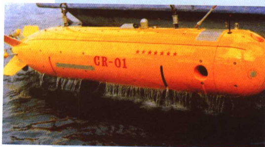
中国科学院沈阳自动化研究所研制开发的水下机器人“CR-01” 6000m 无缆自制水下机器人
