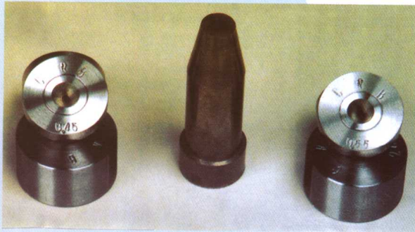
用多晶卡邦 (Carbonado) 金刚石镶制的精密金属拉丝模
