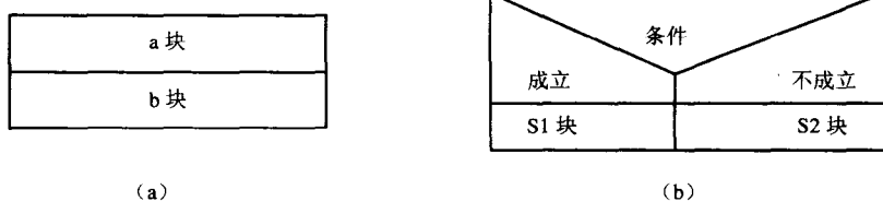
图 1-4 顺序结构、选择结构 N-S 图
