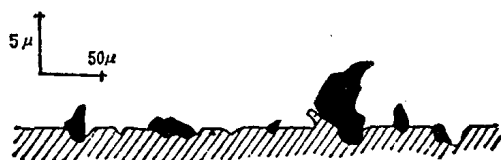
图1-2 上下方向特殊放大的摩擦面简图
