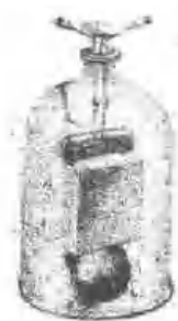
第1圖 置于真空玻璃罩內的電鈴聲音是聽不見的
