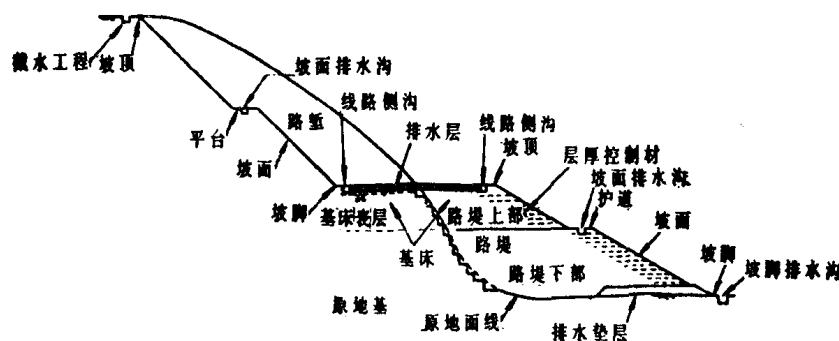
图 1—3—1 路堤和路堑断面图
