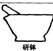
研钵  | 以直径大小表示。有瓷质、玻璃质、玛瑙质、铁质 | 用于研磨固体物质          | 放入量不超过容积的1/3<br>易爆炸物只能轻压, 不能研磨 |
