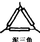
泥三角 | 铁丝弯成, 套有瓷管。有大小之分       | 架放坩埚时用            | 灼烧后小心取下, 不要掉落                  |
