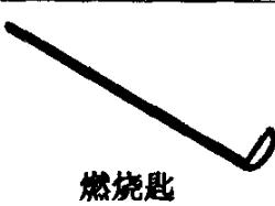
燃烧匙 | 铜或铁制品                  | 检验物质可燃性时用         | 防止锈蚀                           |
