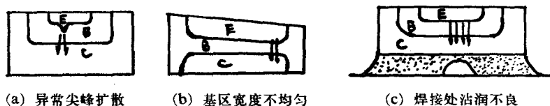
图 13 工艺不均匀造成电流集中
