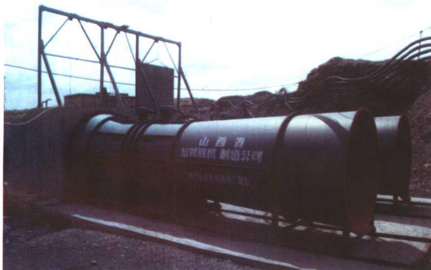
97 - 2 - 12 新型、高效、 节能、低噪声 BD 系列 (NO16、 NO24) 防爆对旋轴流式通风机的 研制 (山西运城风机厂 提供)
