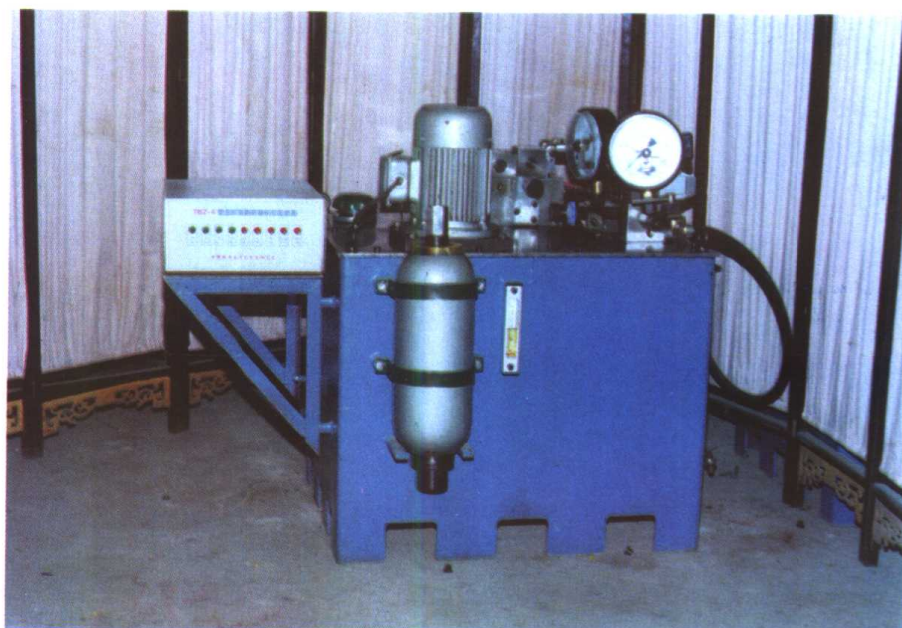
97 - 3 - 21 提升机盘式制动器补偿增压装置 (中国矿大 提供)
