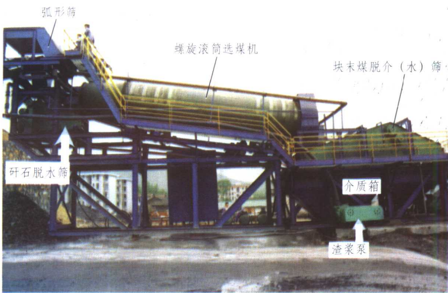
93 - 3 - 69 LZT18/90 型自生介质螺旋滚筒选煤机的 研制 (中国矿大 提供)
