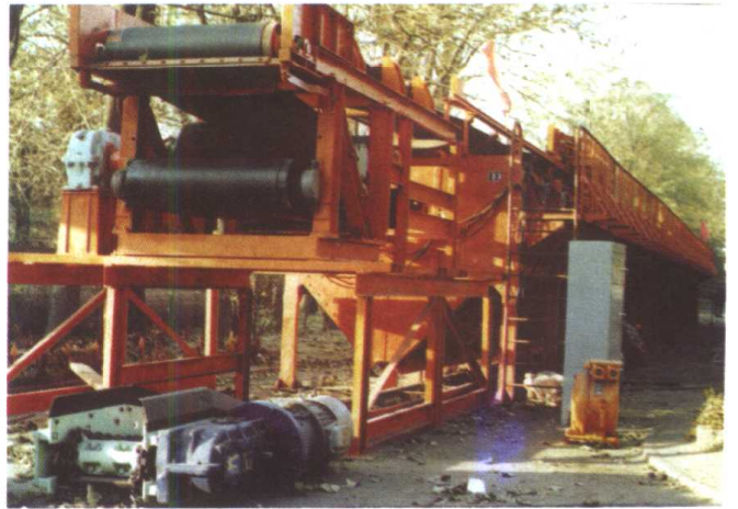
96 - 3 - 08 水平活动煤仓 (山西矿院 提供)
