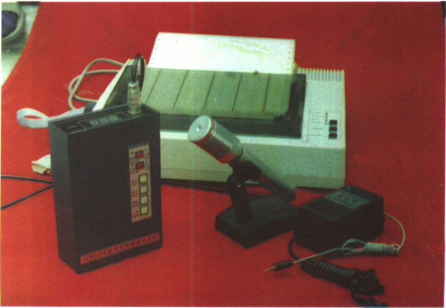
91 - 3 - 47 AZWJ - 1. 2 型智能转化瓦斯检测记录 仪 (江苏煤研所 提供)
