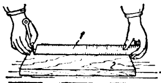
圖13 毛坯上必須要尺寸的劃綫： 1—直尺；2—毛坯。
