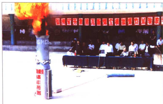
集团公司瓦斯煤尘模拟爆炸试验教学现场
