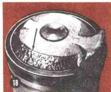
在不断的撞击下, 松动的嵌环使活塞头部的棱边碎落(图 18)。
