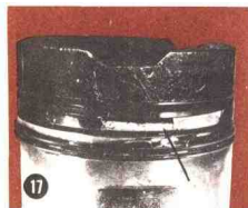
在图 17 中, 铸铁嵌环松动, 并将它下面的活塞环槽脊斩断。
