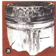
活塞常常因抱缸而在活塞销孔处破碎, 偶而也由于发动机超速转动造成同样结果。如果活塞抱缸造成破碎, 活塞上将有强烈的划伤痕迹(图 20 箭头所指)。如果破碎的活塞实际上没有划伤痕迹, 则销孔处的破碎应归咎于发动机超速转动。超速转动几乎均伴有活塞撞击气门的迹象。乙醚过量、喷油角提早和供油过量是活塞破碎的最常见的原因。
