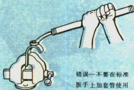
图 17 — 不要在标准扳手上加装套管
