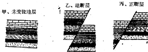
图 8 正断层和逆断层
