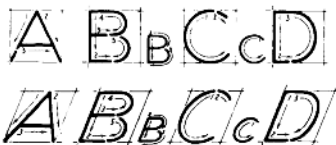
字法：工程畫所用標準字法，一般採用“商用哥德字體（Commercial Gothic）”，垂直字體及傾斜字體亦在採用之列。
