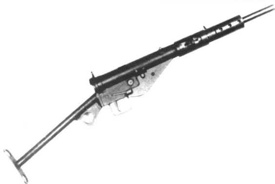
一种作用可靠、 加工容易、价 格低廉的冲锋 枪——英国司 登冲锋枪(1941)
