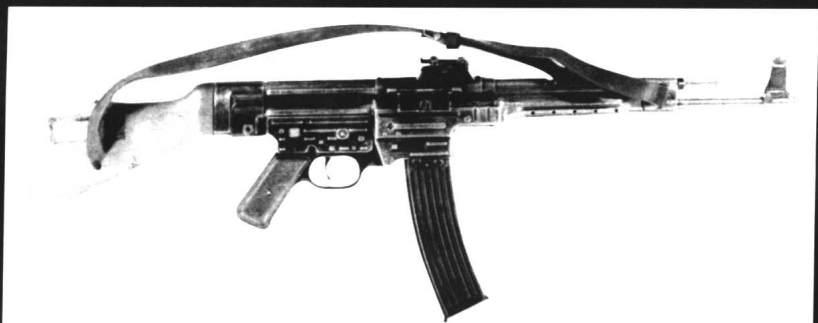
世界上第一支突击步枪——德国 7.92 毫米 MP44(1944)
